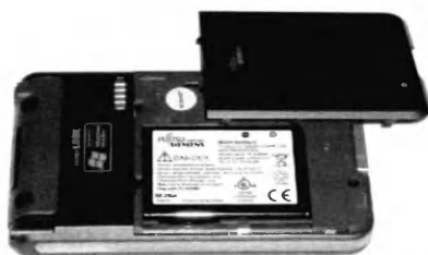
Заменяемый литий-ионный аккумулятор в КПК Pocket LOOX 420
